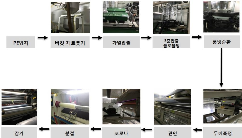
PE/CPP 보호막 생산공정은 다음과 같습니다. 생산된 PE/CPP필름은 코팅기를 거쳐 코팅이 되며, 이를 건조 후 Roll 단위로 포장이 됩니다. 다만 적정한 코팅 및 건조과정을 거쳐야하는 바 당사의 경우 철저한 제품검사를 통해 불량품을 줄이고자 합니다. 제품검사를 통과한 필름은 숙성실을 거친 후 제2차 제품검사를 통과 합니다. 통과된 제품은 고객의 요구에 따라 분절되고 포장되어 출하 준비를 마치고 있습니다.
